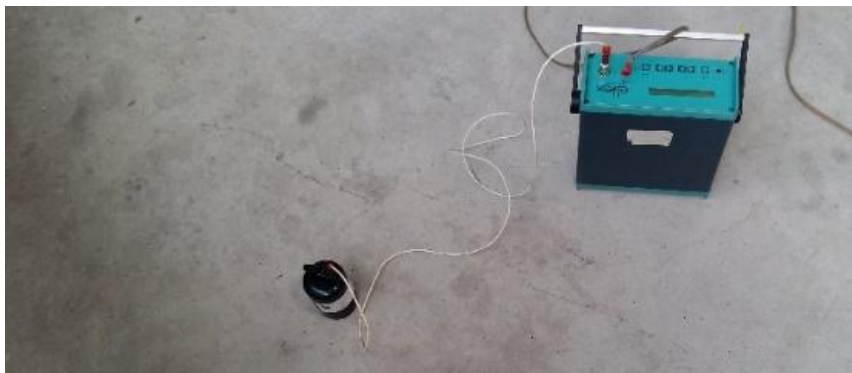
Rys. 4. Pomiar rezystancji upływu R_u [ \Omega ] posadzki antyelektrostatycznej przy użyciu przyrządu pomiarowego Tera-Ohm-Meter 6206 (prod. Eltex) oraz elektrody pomiarowej o nacisku F = 25 N (fot. S. Świątek-Żołyńska).
